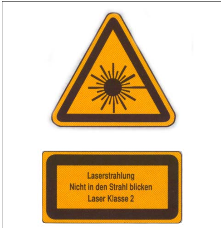
Bild 4.1: Warnzeichen und Beschriftung für den Gefährdungsgrad
