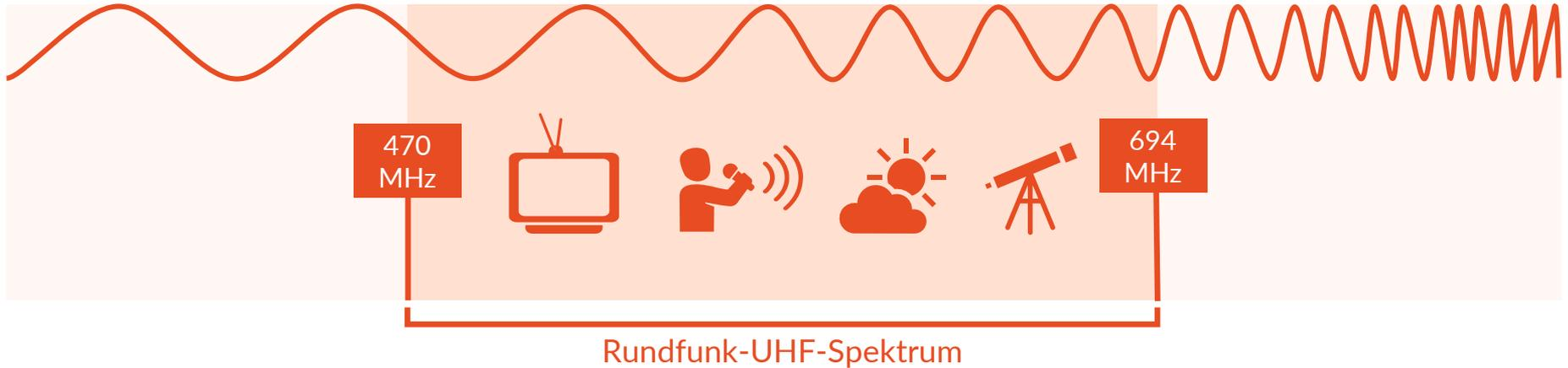
Das Rundfunk-UHF-Spektrum umfasst heute den Bereich zwischen 470 und 694 MHz. Hauptnutzer ist der Rundfunk, der über diese Frequenzen seine Fernsehangebote terrestrisch überträgt.
