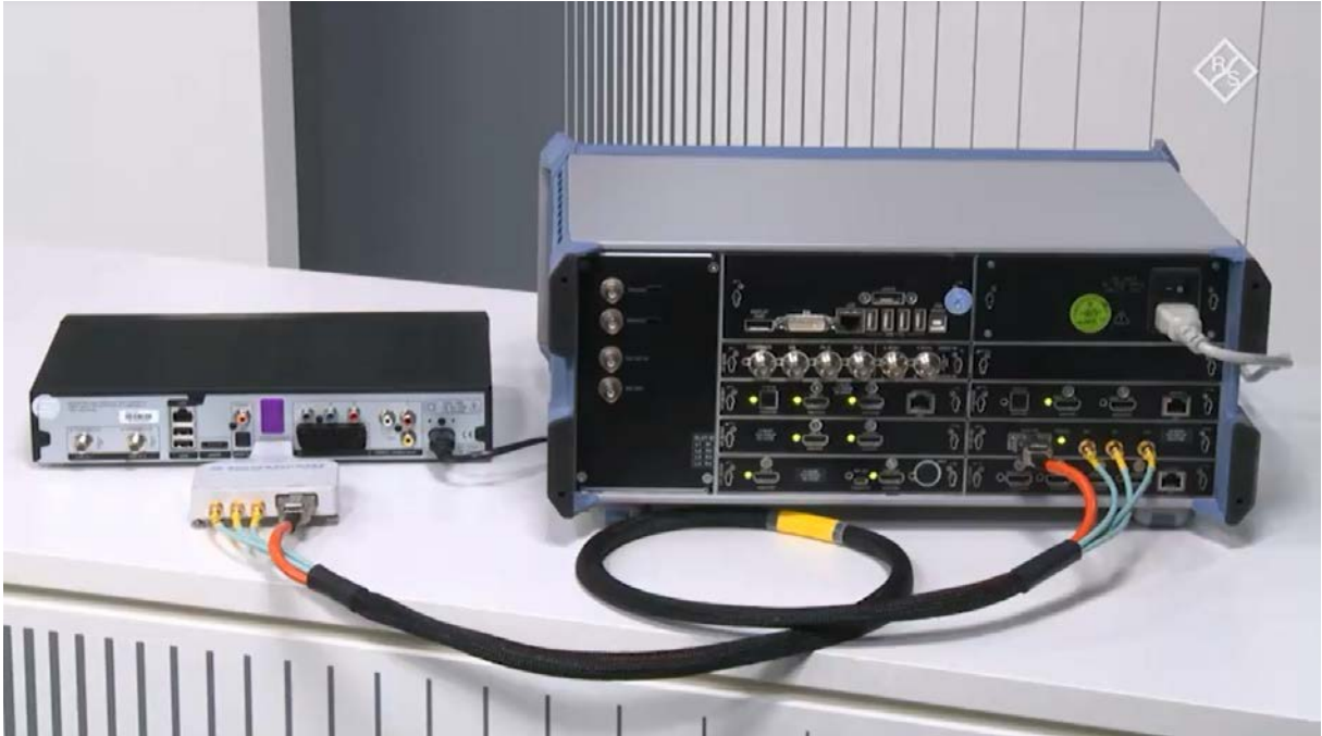
Abbildung 21: Messsystem mit zugehörigem Messadapter von R&S, hier verwendet zur Messung einer Set-Top-Box.
